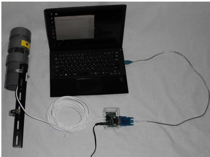
左図のように WM7-RP の下部から出ているモジュラーケーブルを WM7-E β PC インターフェース基板に接続し、さらに RS232C-USB インターフェースケーブルで PC に接続してください。
