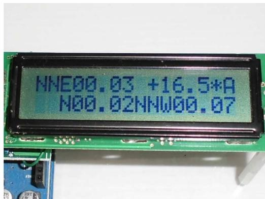
下の行の左側に 10 分間の平均風向風速が、右側に最大瞬間風向風速が表示されます。
